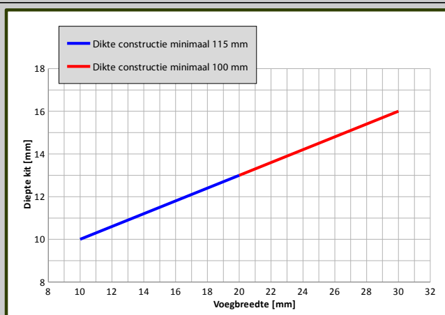
Grafiek: minimale diepte kit in samenhang met de voegbreedte
